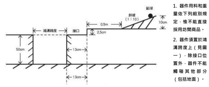
3. 測試:用鉛球(直經約11.8cm,重3千克)將置於一斜坡(1:10)離枱面10cm(垂直距離) 的位置上。鉛球從靜止狀態沿斜坡滾下,經過器件,橫渡鴻溝(跨度為1m)。成功讓鉛球滾過 的設計,以較輕者為優勝。
